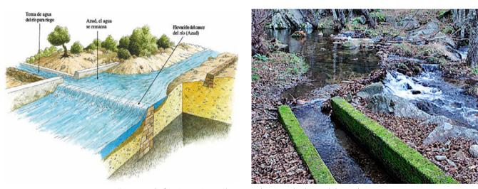
Esquema de funcionamiento de un azud y ejemplo de azud de madera.
